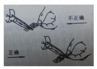
(2) 当使用模具进行大量引线的成型时,必须设置固定引线的机构,要注意引线压杆机构不能对器件本体施加压力,如下图:
