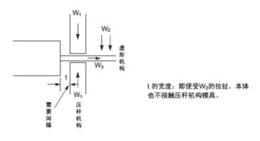
(3) 引线弯度不宜超过 90°, 当弯成 90°时,弯曲部位与引线根部间距至少为 3mm,此外,绝不允许横向弯曲引线或反复弯折引线,否则极易因不适当的应力而破坏器件内部连接或使引线和塑封料之间产生裂
